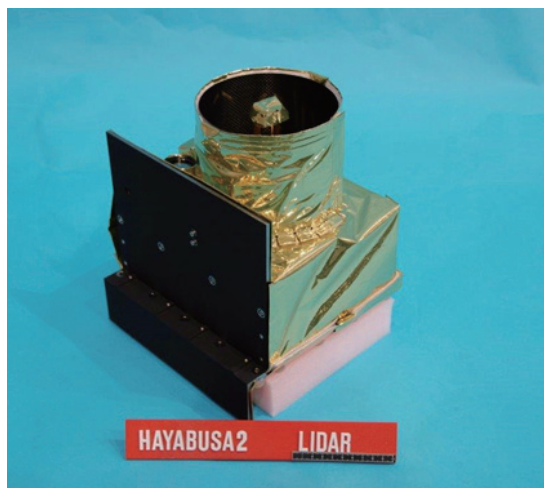
図2: LIDARフライトモデル外観。
